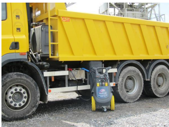
Figure 1: PROPULSTATION : Booster de batteries mobiles pour utilisation professionnelle intensive
